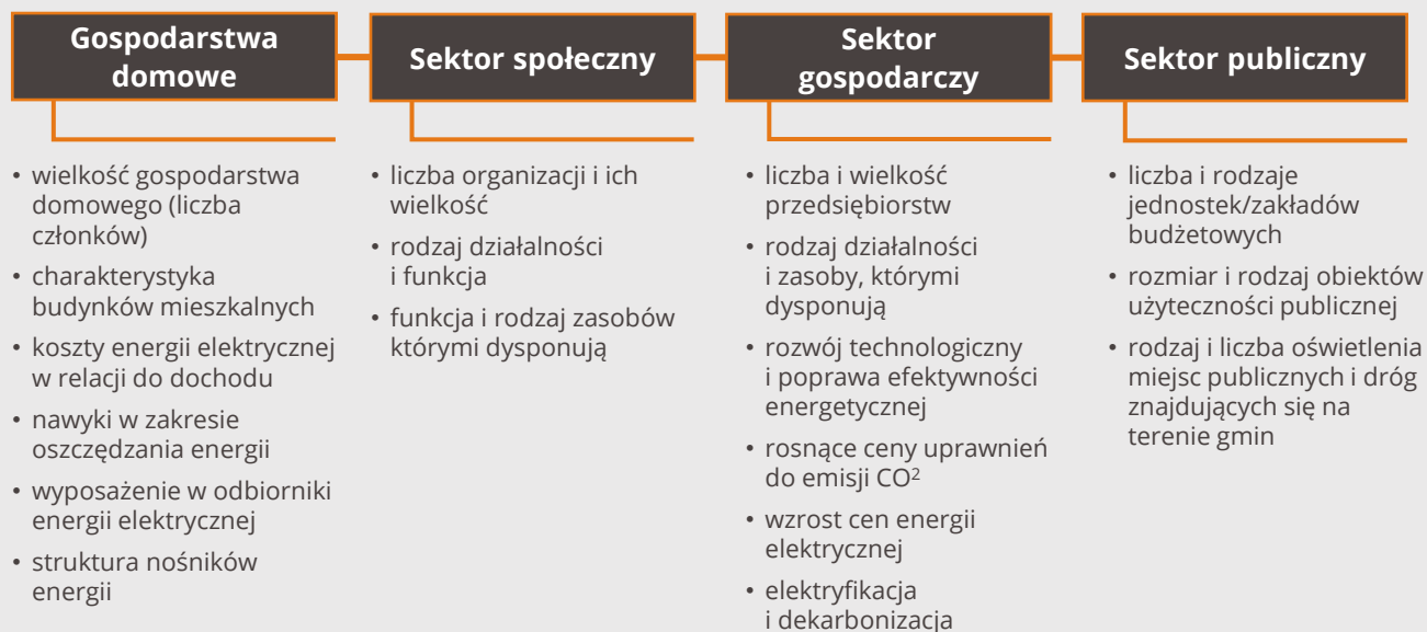
Rysunek 5. Czynniki wpływające na zapotrzebowanie na energię elektryczną, ciepło i paliwa gazowe w poszczególnych sektorach
